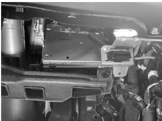
運転席ダッシュのアンダーカバーを外します。足元ダクトの固定ピンを外し除けます。オーディオユニットの取り付けボルトを外し抜き下げます。
