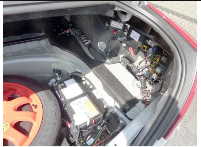
オプションのスイッチを取り付ける場合、 トランク右トリムを取り外します。 (スイッチ延長コードも必要です)
