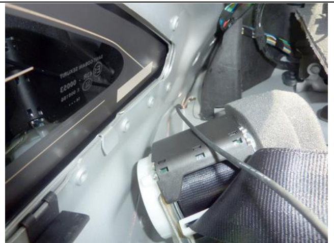
シートベルトリール奥のボディーパネル継ぎ目から スイッチ延長コードを挿入します
