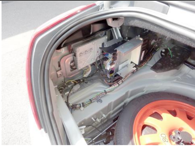
トランク左トリム内に エンターテイメントECUがあります
