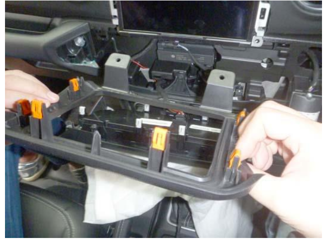
ディスプレイ周りのフィニッシャーを外し ディスプレイを外します
