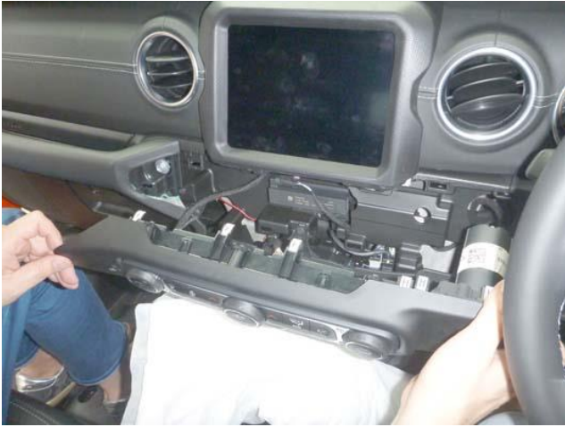
パターン1 ディスプレイ下のコントロールパネルを外す
