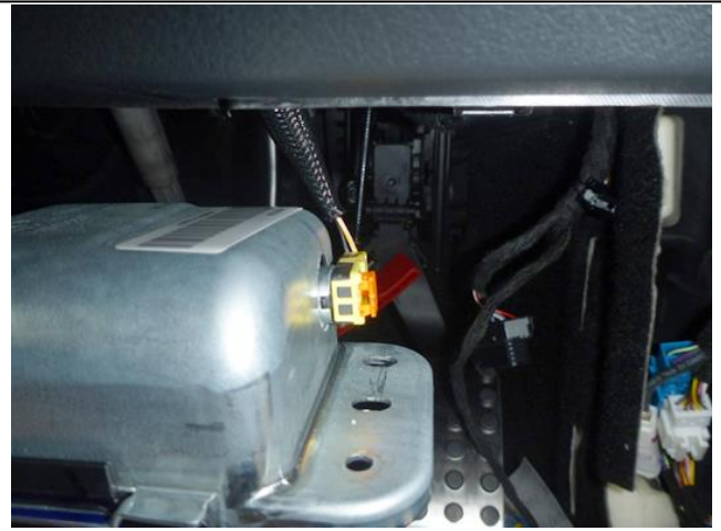
エアバッグの配線を外さない キーOFFでも警告灯が点灯します
