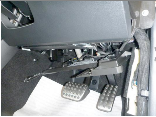
運転席側ダッシュアンダーカバーを外します
