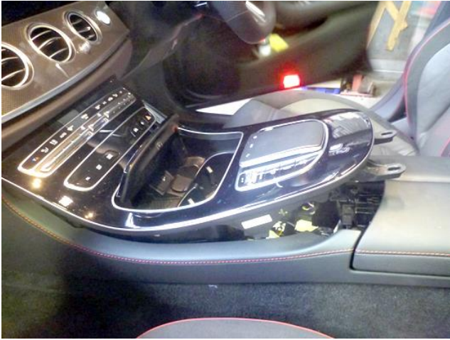
センターコンソール操作パネルを外します
