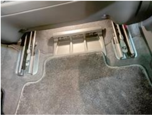
シートレールを外します
