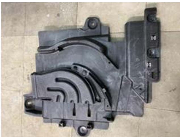
足元ダクトを外します
