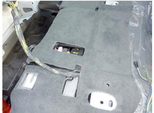
カーペットの一部をめくると プラスチックカバーの穴に コネクターが見えます
