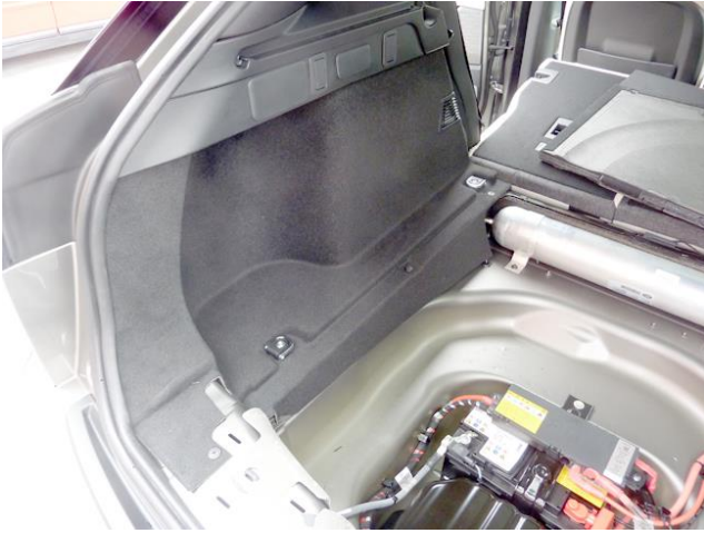
ラゲッジルーム左の内貼りを外します
