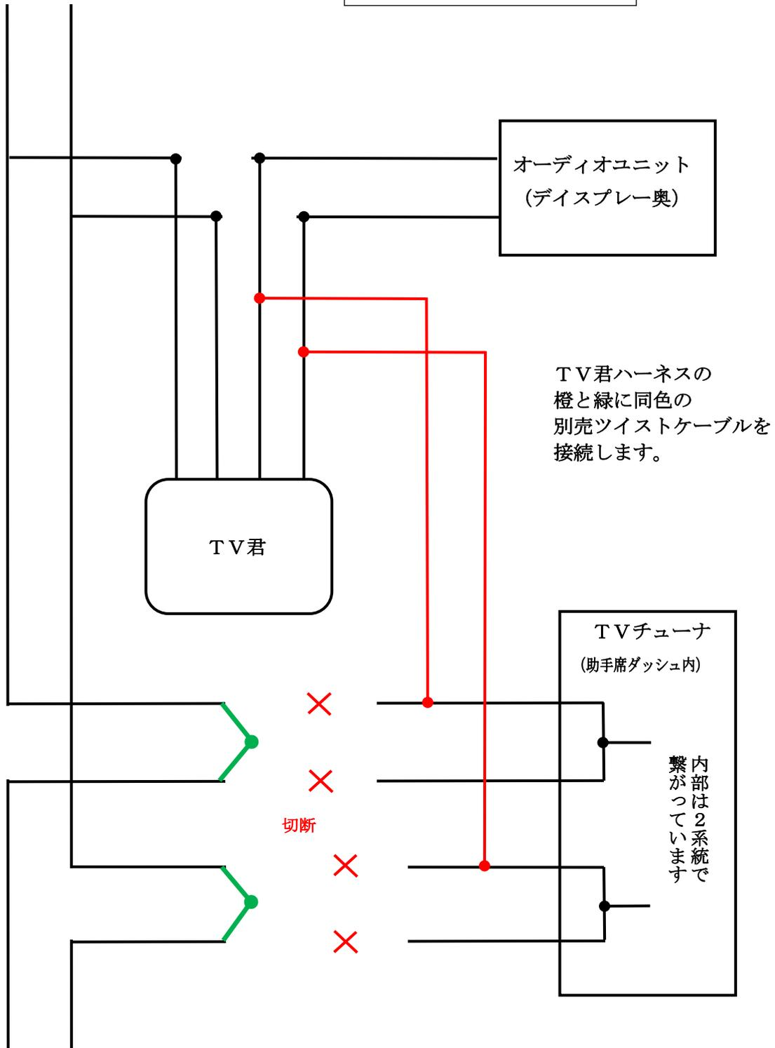
チューナCAN配線を切り、配線接続図を参考に配線します。車両からの配線は、同系統を接続しテープ等で絶縁します。
